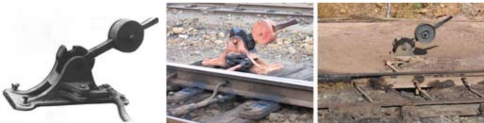
Izquierda. Palanca con contrapeso manual para el cambio de vía, años 50. Foto A.F.R.T. Centro, palanca original repuesta en la playa de vía de Zarandas, año 2009. Foto ADD. Palanca con contrapeso reproducida ubicada en la playa de vías de Los Frailes, año 2007. Foto ADD.
