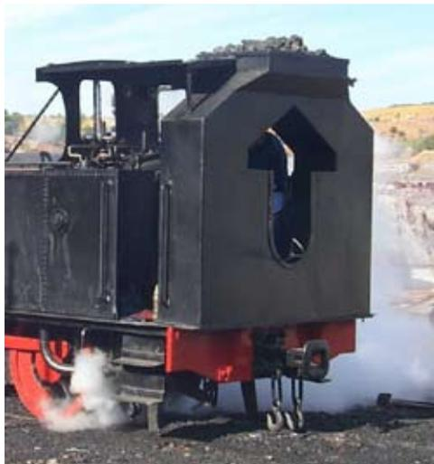
Dibujo y fotografía del tender de carbón en forma de pantalón de la locomotora nº 14 propio de las locomotoras del Río Tinto Railway. Foto y dibujo ADD.
