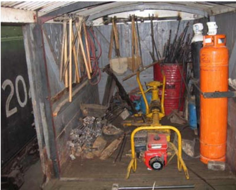
Interior de Furgón de mercancías con herramientas para la reparación y mantenimiento de la vía.
