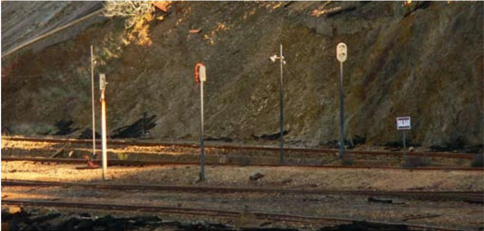
Detalle de la señalización de la foto superior, donde también se aprecia señalización vertical y sistema manual de cambio de vía junto a la Estación de Zarandas, año 2009. Foto ADD.
