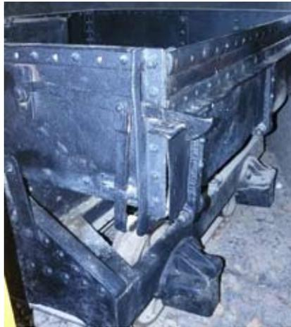
Vagón de Vuelco Simple tipo B<sub>2</sub> instalado en la sala nº 12 del Museo Minero de Riotinto, año 2009.
